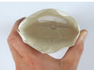
Dank aufkaschierter OPP-Folie ist die Kartonverpackung innen dicht wie ein Beutel.
